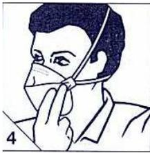
4. Ajuste o elástico superior sobre a parte de cima da sua cabeça. Ajuste o elástico inferior no pescoço, posicionando abaixo das orelhas. Certifique-se de que os elásticos estejam colocados de maneira correta, e que não fiquem torcidos. Para uma vedação adequada e confortável, ajuste o painel superior e inferior.
