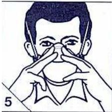
5. Coloque as pontas dos dedos de ambas as mãos na parte superior do clipe de ajuste nasal. Deslize as pontas dos dedos por toda a extensão do clipe nasal, moldando-o de acordo com o formato do nariz. Atenção! Lembre-se sempre que o uso de apenas uma mão pode causar um ajuste inadequado e interferir no desempenho e na vedação do respirador.
