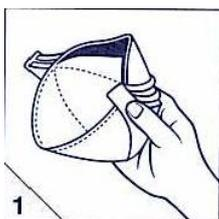
1. Remova o respirador da embalagem e abra-o totalmente puxando as abas inferior e superior com as duas mãos moldando o clipe de ajuste nasal com o dedo polegar no centro da espuma interna. Note que esse movimento molda facilmente o formato de concha.
